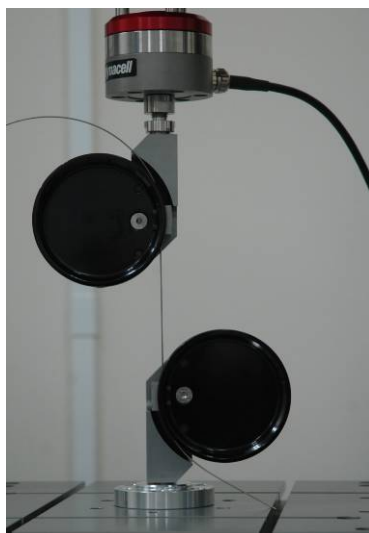
チタンワイヤーの引張疲労試験状況
