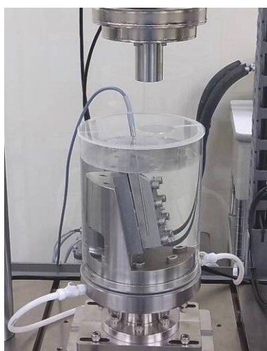
水溶液中測定装置
