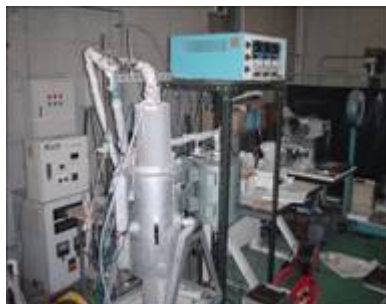
バイオマス燃焼試験装置
