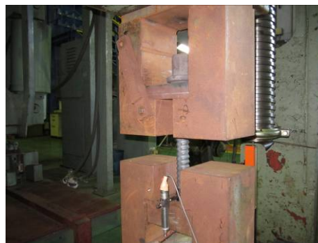
定着具の性能評価試験状況写真
