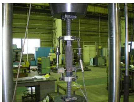
鉄筋継手性能判定試験状況写真
