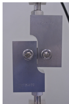
コーティング材の引張剪断疲労試験 試験概観(右)、試験部拡大(左)
