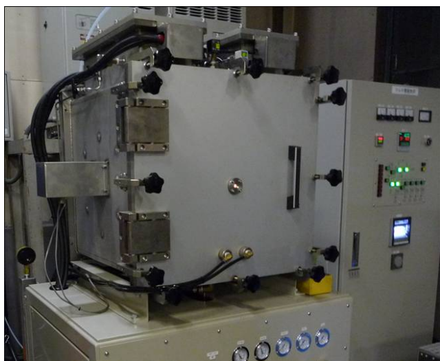
各種雰囲気に対応する多機能電気炉（最高1600℃）
