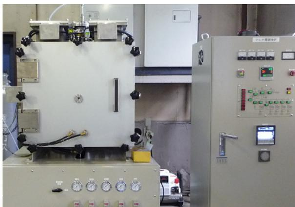
各種雰囲気に対応する多機能箱型電気炉（最高1600℃）
