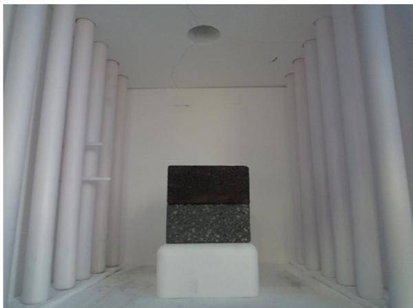
多機能箱型電気炉での異種材料積載試験
