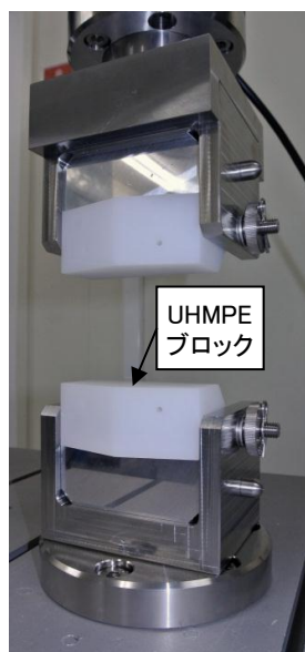
図1 UHMWPEブロック及び試験用具
