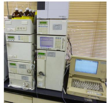
図 高速液体クロマトグラフ(HPLC)分析装置
