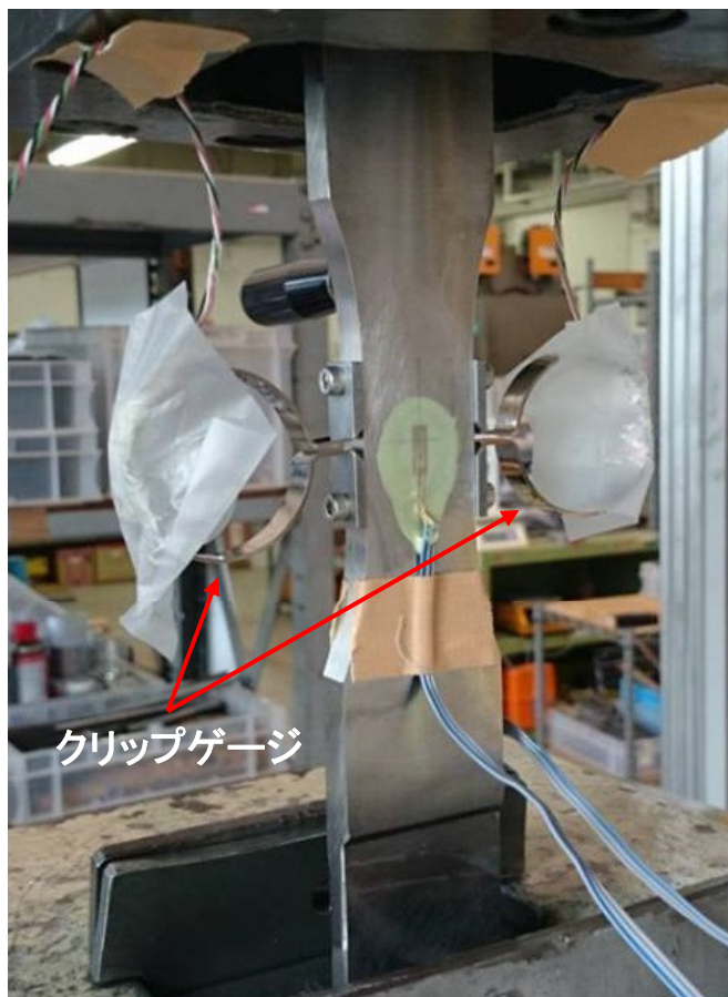
写真1 試験例(クリップゲージ装着)
