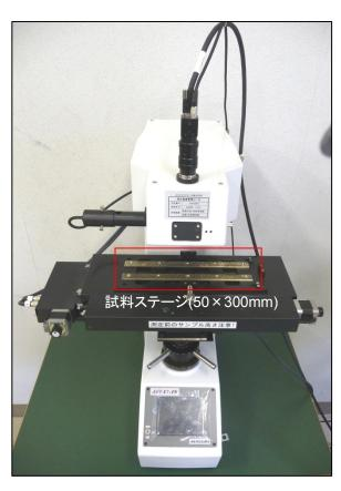
試験方法 JIS Z 2244 「ビッカース硬さ試験ー試験方法」
