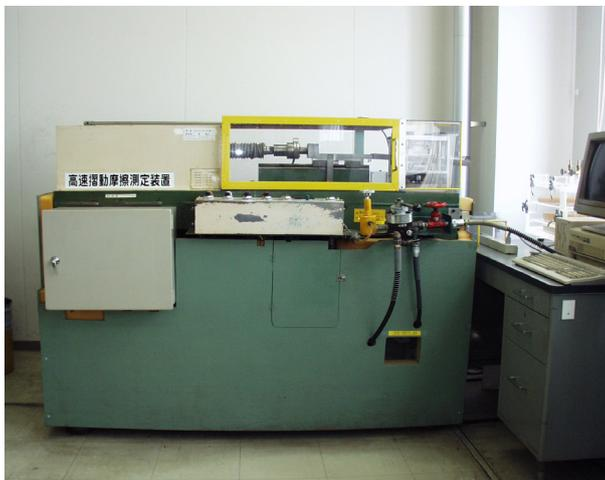
高速摩擦摺動試験装置
