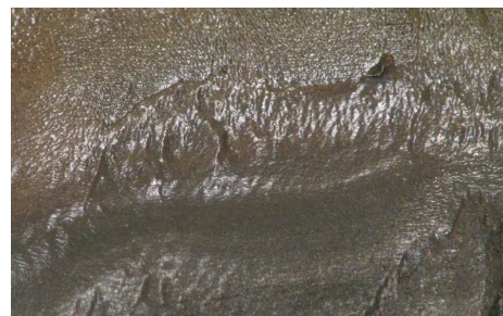
図3 シェリング損傷の破面の一例
