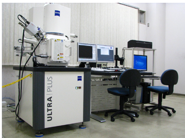
極低加速電圧SEM (カールツァイス社製 ULTRA plus)
