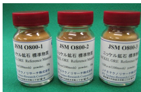
写真1. ニッケル鉱石標準試料（3種類）
