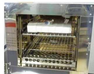
図1 低温環境器内試料設置部
