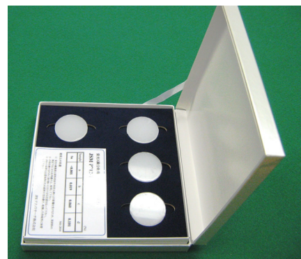
図1 プラスチック中のスズ含有量を分析するための標準試料
