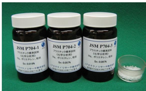
写真1 プラスチック標準試料 (3種類)
