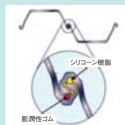
図1 止水材の装填充填
