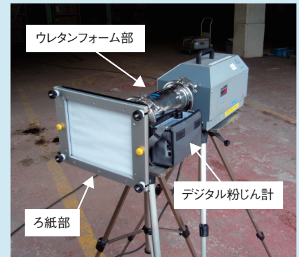
写真 作業環境ダイオキシン類測定
