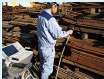
写真 鋼材の表面に当てて材料分析を 行っている様子
