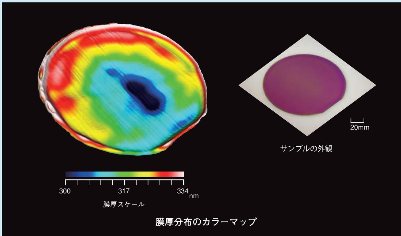
図 窒化膜の膜厚分布測定
