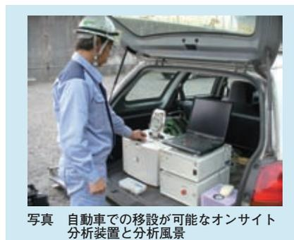
の優れた検出感度を有し、100ppm以下の微量濃度域においても含有量と測定強度には強い相関が得られます。定量は、このような相関曲線(検量線)を用いることで精密定量しますが、検量線作成が難しいケースでは、X線強度を理論計算して含有量を推定する簡易定量法(ファンダメンタルパラメータ法)などを利用することで、スクリーニング評価が可能となっています。
