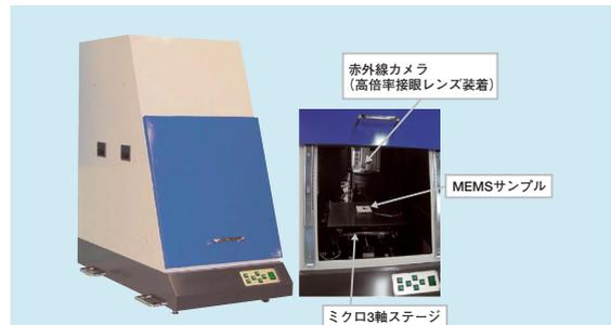
図1 MEMS応力観察装置
