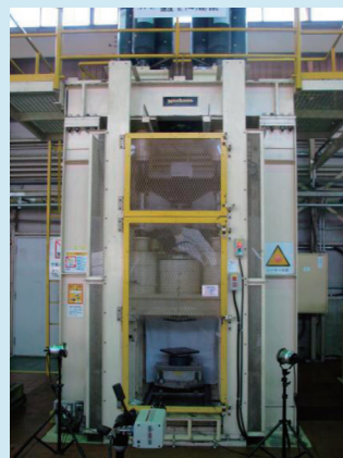
図1 高速変形（圧潰）試験機
