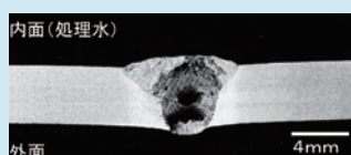
図1 ステンレス鋼の溶接部に発生した微生物腐食
