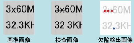
図2 文字部欠陥検出例
