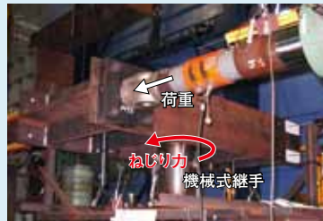
写真1 ねじり耐力確認試験
