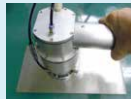
写真1 ドライ超音波カメラによる鋼板探傷例
