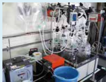
図1 バッチ式試験装置 (2L/基×4基)
