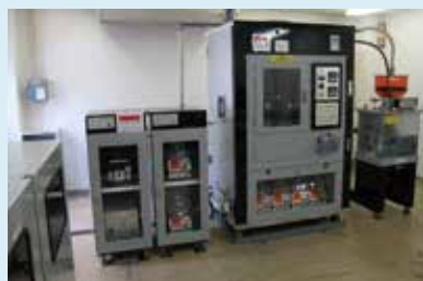
写真1 オゾンガス導入可能なガス腐食試験機
