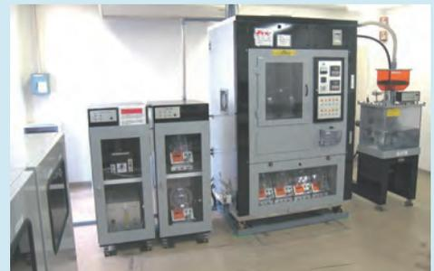
図2 微量ガス腐食試験機
