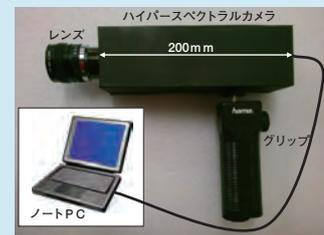
写真 ハンディタイプハイパーイメージング分光器の機器構成
