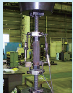
図2 鉄筋継手性能判定試験状況
