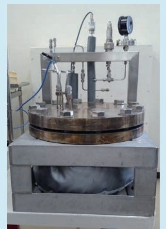
写真 低圧過酷環境暴露試験機
