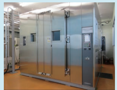
図2 超大型サイクル腐食試験機(2号機)
