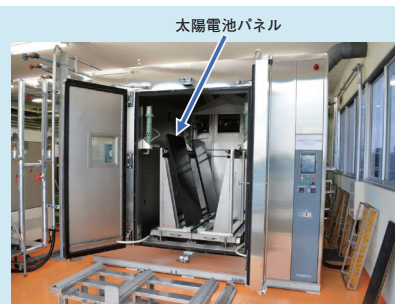
写真1 超大型サイクル腐食試験機による大型太陽電池パネルの塩害試験
