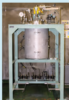
写真 オートクレーブ腐食試験機
