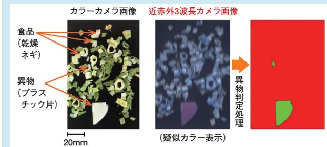
図1 本カメラを用いた食品中の異物検査例
