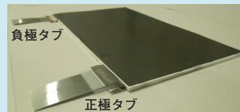
図4 積層電極型セルの外観(Dタイプ)
