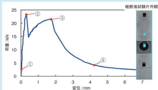
図1 セン断引張試験で得られた荷重-変位曲線
