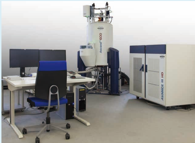
図1 クライオプローブ搭載600MHz核磁気共鳴分析装置(NMR)
