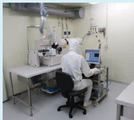
図2 クリーンルーム内の高感度ICP質量分析装置
