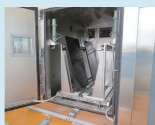
写真1 超大型CCT試験機(太陽光パネル装入時)
