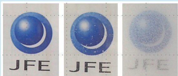
写真1 ポリカーボネートのグラベロ試験 (空気圧:0.4MPa, 射出時間5秒/回) (左:試験前、中:玄武岩6号砕石500g、右:ケイ砂500g) 透明な試験板の背景にJFEマークを置いて撮影
