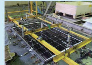
図4 太陽電池モジュールの耐風圧試験
