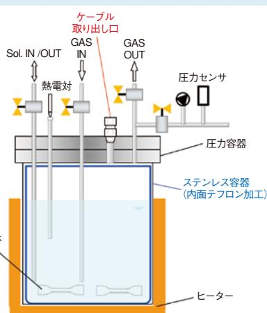
図1 圧力容器の概略図
