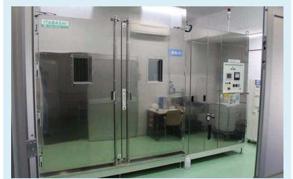
図1 重量物対応CCT試験機
