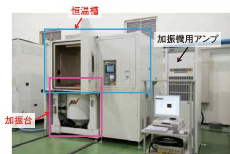
図1 減衰特性評価試験システムの概要
