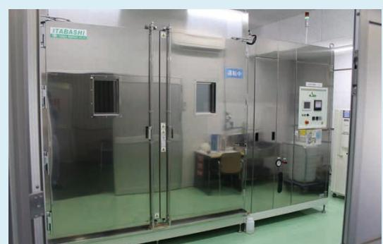
写真1 重量物対応CCT試験機
