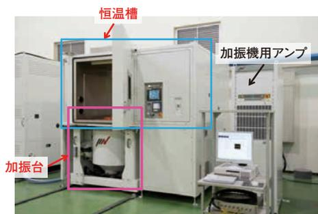
振動試験装置の外観
