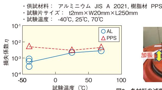
図2 各材料の減衰特性の温度依存性(試験例)
