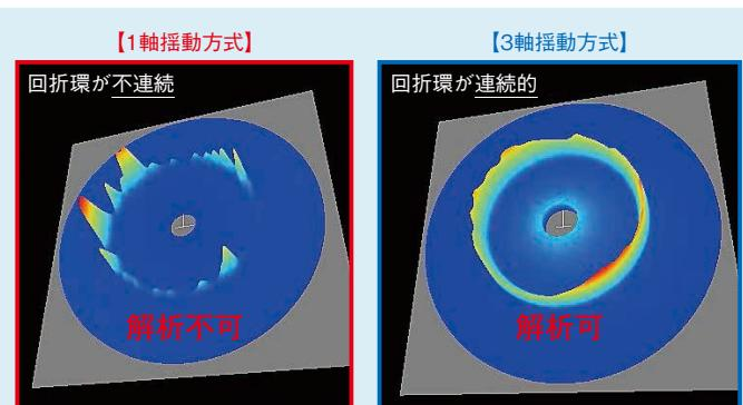
図1 摆動方式の違いによるX線回折環比較(結晶粒径: $90\mu\text{m}$ )
