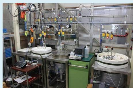
写真1 圧力容器の試験設備
