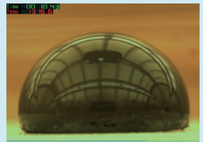
写真2 酸化物粉末の熔融
