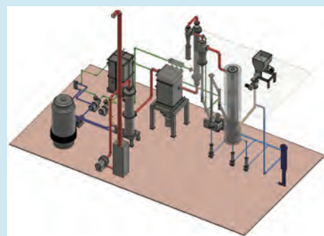
図2 管状炉を用いたバイオマス燃焼試験装置の基本設計例
