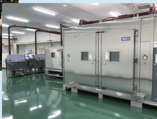
写真2 試験棟内部のCCT試験装置群
