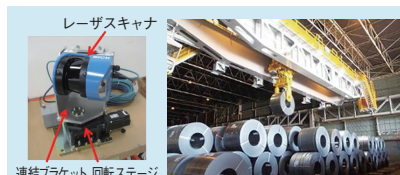
図1 3次元レーザスキャナ:単体(左図)、クレーン上の設置状態(右図)
