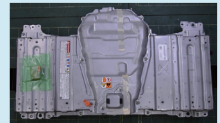
図1 バッテリーパック(ハイブリッド車)
