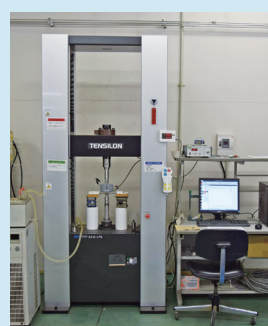
写真2 水素脆化評価のためのSSRT試験機
