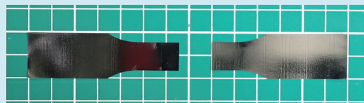
図2 ナノ結晶軟磁性材料の疲労強度試験後外観
