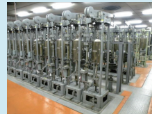
図1 当社クリープ試験設備の一部
