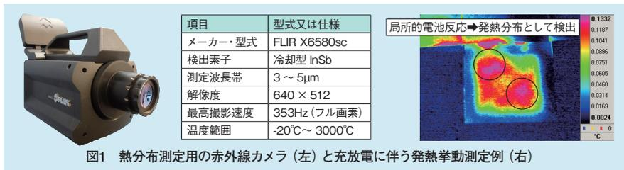
図1 熱分布測定用の赤外線カメラ(左)と充放電に伴う発熱挙動測定例(右)
