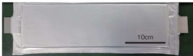
図1 試作した100Ah LIB外觀写真
