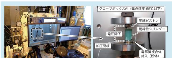
図1 大気非暴露環境中の圧粉成形と電気抵抗測定系
