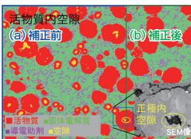
図2 正極合材断面のセグメンテーション結果
