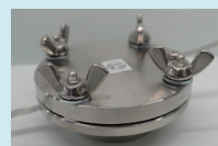
写真2 SIB正極ハーフセル (外装体：宝泉製フラット型セル)
