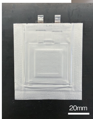
写真1 塗工式ラミネート型 全固体電池外観
